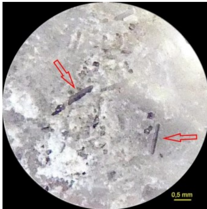
Fig. 16 - Quest'immagine è particolarmente interessante per lo studio genetico del deposito mineralogico. Si vedono, infatti, diversi piccoli cristalli allungati di quarzo entro la barite e la calcite. Le frecce indicano i due più evidenti. Come si nota, poi, in fig. 15, questi cristalli possono essere molto abbondanti.
