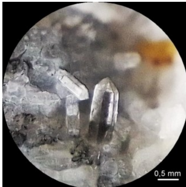
Fig. 15 - Cristalli di quarzo entro piccole cavernosità nella roccia, dopo trattamento con HCl.
